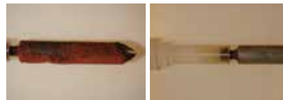
取り出した金属棒の 表面を軽く拭き取った 結果表面に錆び発生なし。
