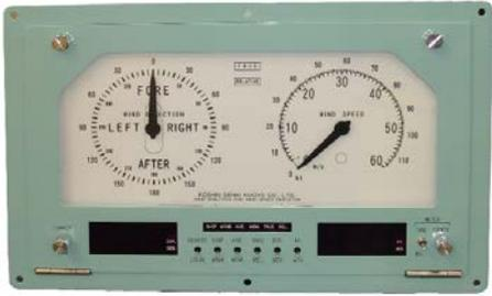
KV-5025 型船舶用風向風速計は、視風向風速信号（風向風速発信器からの信号）と船舶信号（船速、進路信号）を入力することにより、対船真風向風速を演算し、指示します。指針とデジタル表示を併用したデジアナタイプの船舶用風向風速計です。
