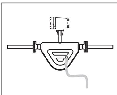
⑧ガス用で圧力が1MPaを超えて使用する場合は検出器ハウジング背面にバースティング(安全弁:NPT3/4本体側オネジ)が付くのでホース等で万一の開放処理を推奨します。
