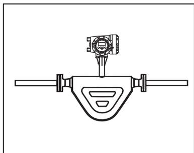
①水平配管に取り付ける場合は変換器(分離形の場合は端子箱)が上側になるよう設置してください。
