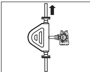
②垂直に取り付ける場合は流れ方向が下→上になるよう設置してください。
