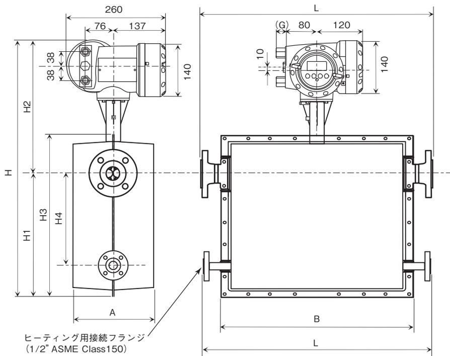
※図の保温ジャケットは液体・蒸気用ヒーティングジャケットを示します。
