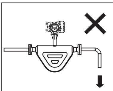
④流量計は常に測定管内が液で満たされるようにしてください。流量計の上流側/下流側配管を下向きにしないでください。また空気がガスが溜まりやすい配管の最上部へは設置しないでください。
