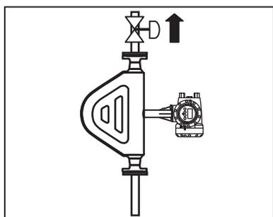
⑦流量コントロールバルブは流量計の下流側に設置してください。これはバルブの絞り構造によるキャビテーションの影響を避けるためです。
