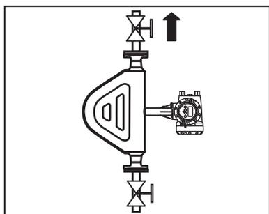
⑤流量計の上下流にバルブを設置して、ゼロ点調整時に必要な満液停止状態を確保できるようにしてください。
