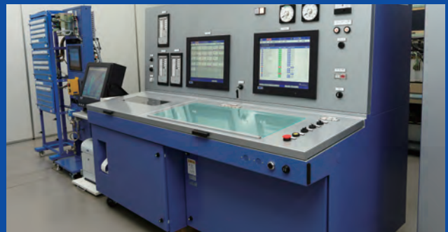
機関監視盤・アラームモニタリングシステムシミュレータ
