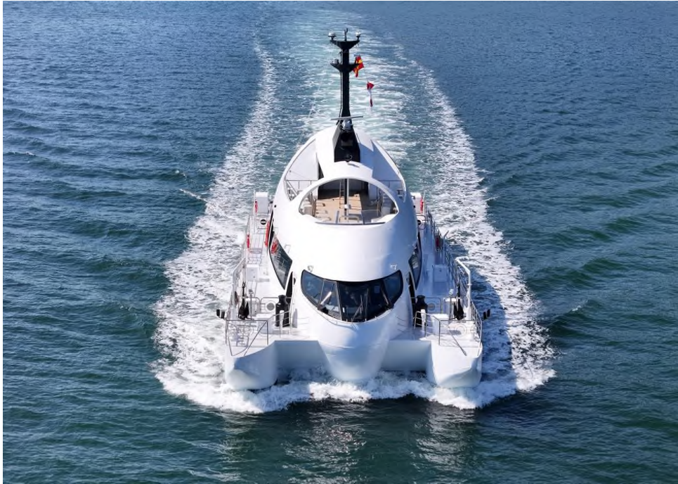
水素とバイオディーゼルを燃料として使用可能なハイブリッド旅客船「HANARIA」
